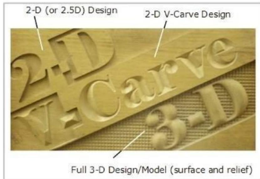
في نحت القطع باستخدام ماكينات CNC، يمكن التمييز بين 2.5D، 2D، و3D بناءً على كيفية تحريك الأداة وتتنفيذ النحت:
